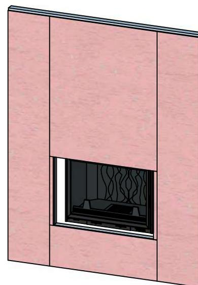
Перед закреплением ЛМ произвести термоизоляцию сертифицированными материалами (см. QR код) согласно противопожарным нормам и правилам
