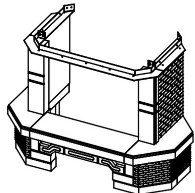
Детали №1а и 1б необходимо перед установкой соединить вместе в соответствии со схемой сборки
